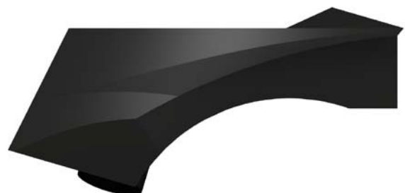
Figuur 64 - Uitsparing voor de pomp steekt minder uit
