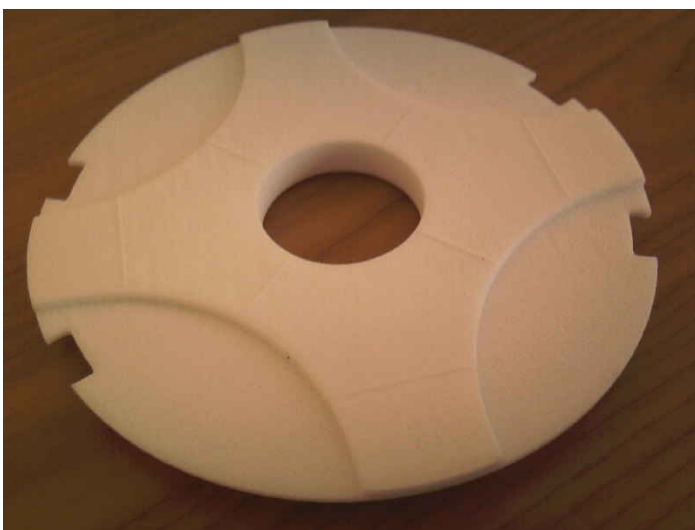
Figuur 6.15 De onderkant van het sensordeksel.
