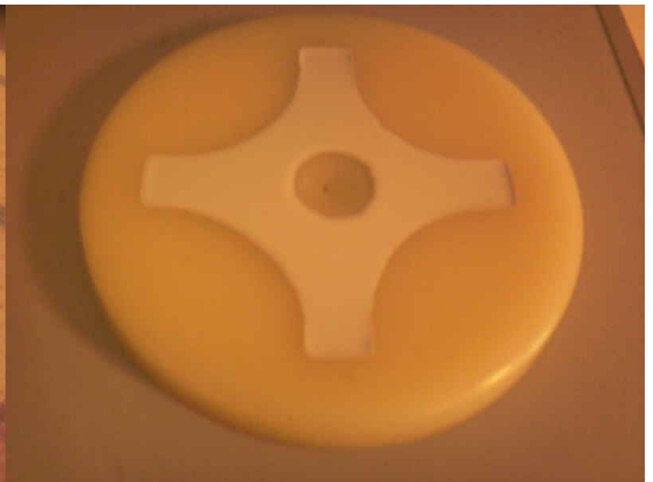
Figuur C.6 Rubber in de rubberen mal, die gegoten is met behulp van het gietstuk uit de rubbermal.
