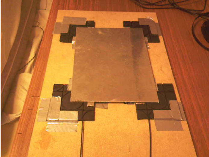
Figuur C.1 Test van het principe van sensorvoetjes.
