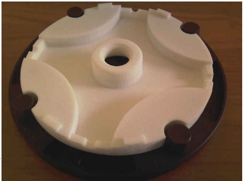
Figuur 6.10 Prototype (11 cm) van de sensorvoet, geplaatst op een al bestaand product.
