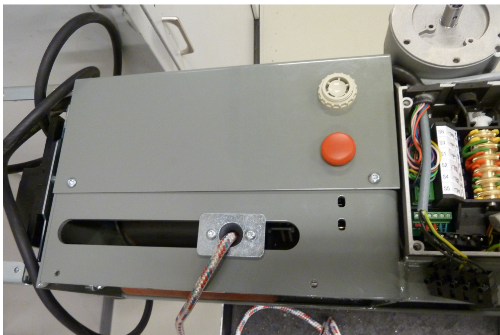
Figuur 40 - De signaalgevers zijn ingebouwd in de kap van de hijsunit
