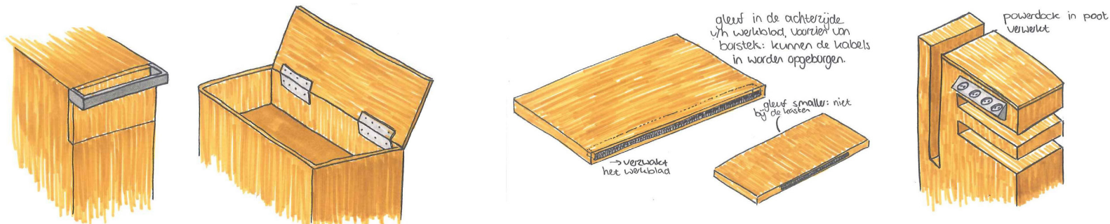
Figuur 34: (Links) Opbergvak bovenin de poot van Concept Scheidingswand. Figuur 35: (Rechts) Bekabeling Concept Scheidingswand.
