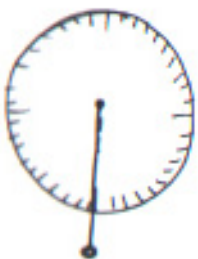
Figuur 29 | Hoek zichtbaar maken door een gradenboog met een touwtje met gewichtje.
