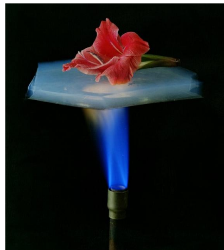
Afbeelding 3.1-h Isolatie door aerogel (Steiner & Walker, 2011)
