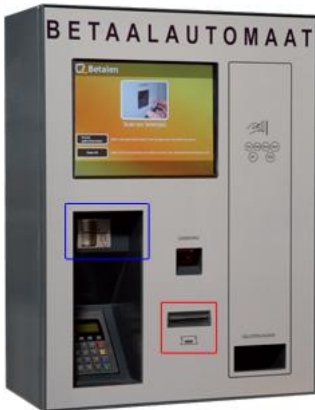
FIGUUR 6: DE OUDE BETAALAUTOMAAT MET PINPAS INVOER EN BONNENPRINTER GEMARKEERD.
