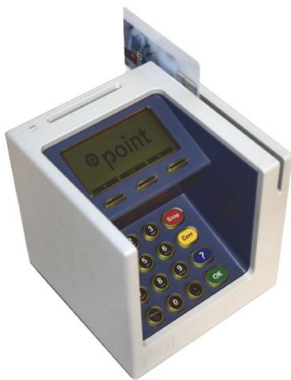
FIGUUR 2: DE XENTA PINTERMINAL MET PASJE IN DE MAGNEETSTRIPLEZER.
