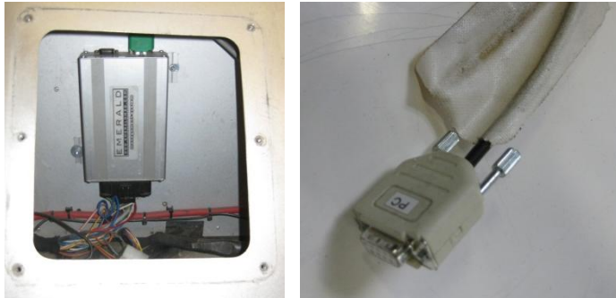
FIGUUR 10-32 ECU EN DE STEKKER VOOR VERBINDING MET EEN PC
