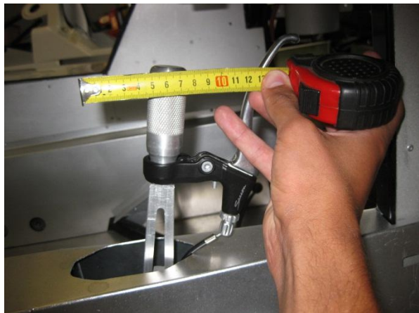
FIGUUR 6-15 ZIJAAANZICHT SCHAKELPOOK EN AFSTAND TOT FRAME
