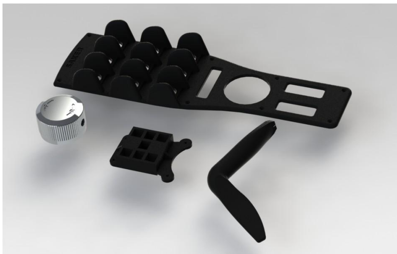
FIGUUR 10-69 REMDRUK-KNOP, RICHTINGAANWIJZERHENDEL, SCHAKELAARBODY EN LEDRASTER
