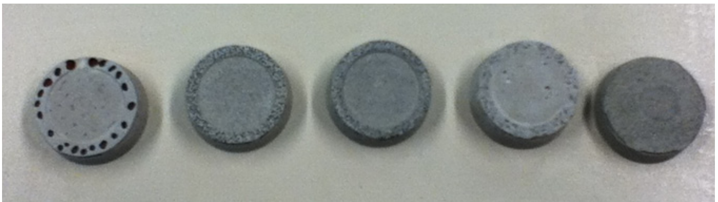
Figuur 23: proefstukken met als vulmiddel, van links naar rechts: glasparsels, silicium carbide, bruin aluminium, spiegelscherven, rubberpoeder.
