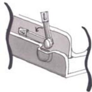
Figuur 4.11 Deel van de zijwand van de kuip en van de tilzitting. De tillussen en clips kunnen in de zijwand verwerkt worden
