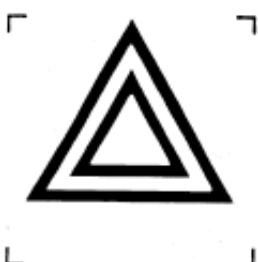
Figuur 10 Waarschuingsknipperlichten ISO 2575 nr. 4.4
