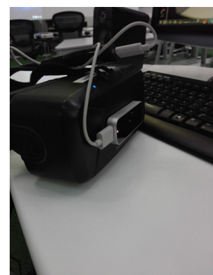
Afbeelding 23: Oculus Rift DK2 met de Leap Motion.
