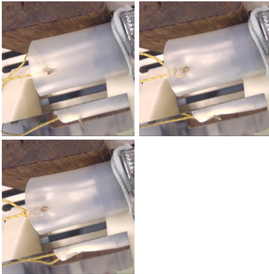
Figuur 1: Weergave validatiemeting, migratie van de schroef. Linksboven: begin meting. Rechtsboven: halverwege meting. Linksonder: vlak voor migratie.
