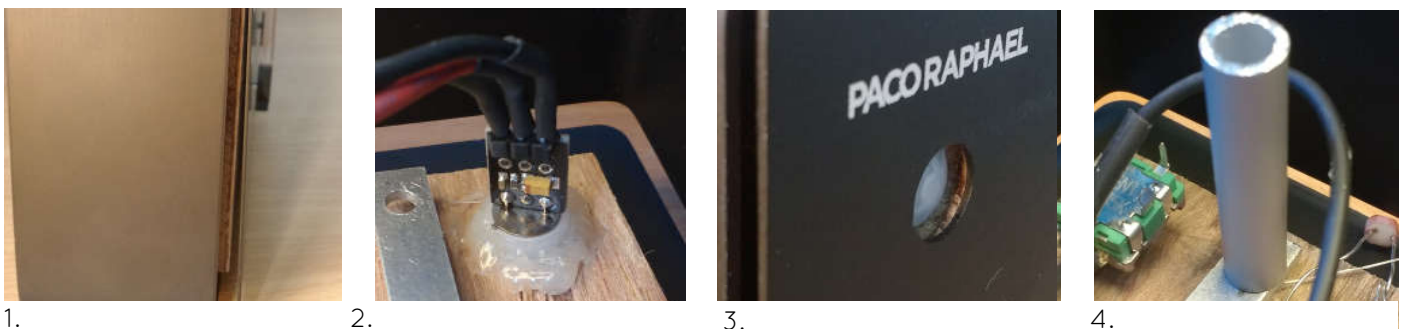
Figuur 4-9: 1. Kier te zien tussen voorplaat en kast. 2. Bevestigingsplaat lijmen. 3. Bevestigingsplaat te zien door voorplaat. 4. Instabiele busjes.
