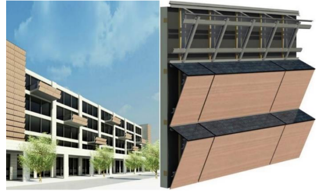
Figuur 10 Zigzag solar system (Heijmans, 2017)
