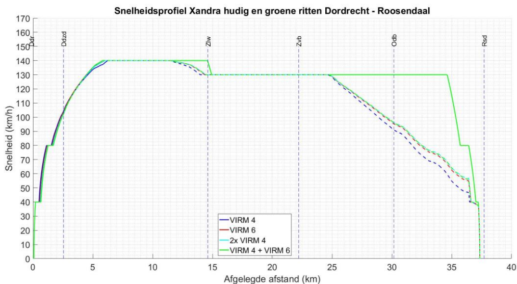
Figuur 3.3 - Snelheidsprofiel Xandra Dordrecht – Roosendaal, doorlopende lijnen: Xandra huidig, gestreepte lijnen: Xandra met negatief snelheidsbord (uitrollen)
