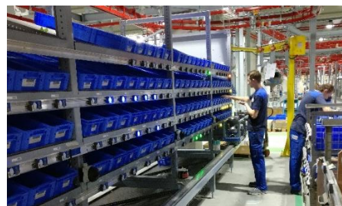
Figuur 3.2: Pick-to-light montage
