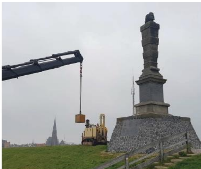
Foto 2.1. Uitvoering seismisch en magnetometersondering Stenen Man te Harlingen
