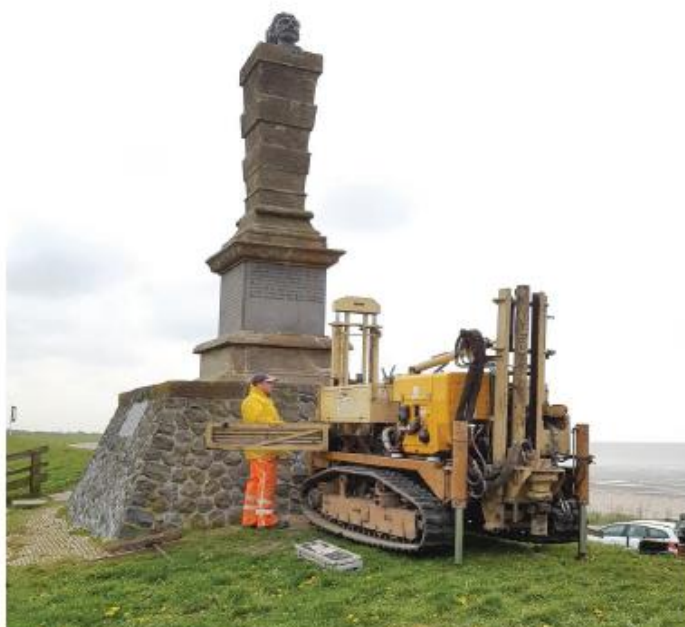
Foto 2.2. Uitvoering seismisch en magnetometersondering Stenen Man te Harlingen
