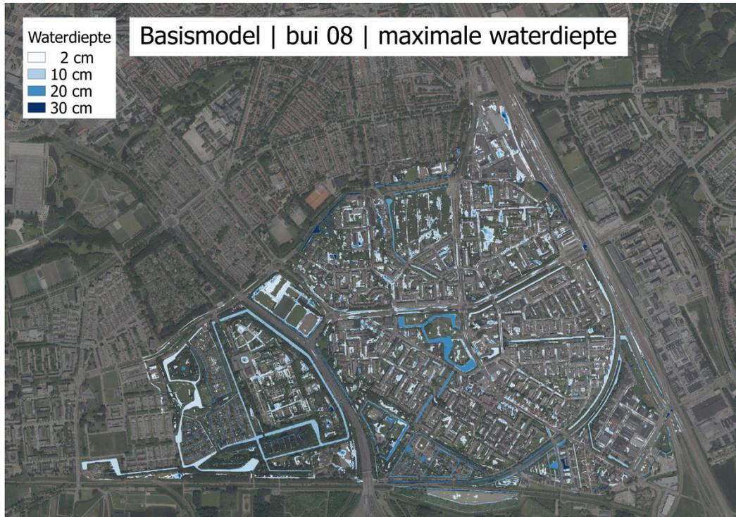
Figuur 26: Maximale waterdiepte [cm] in het basismodel met bui 08
