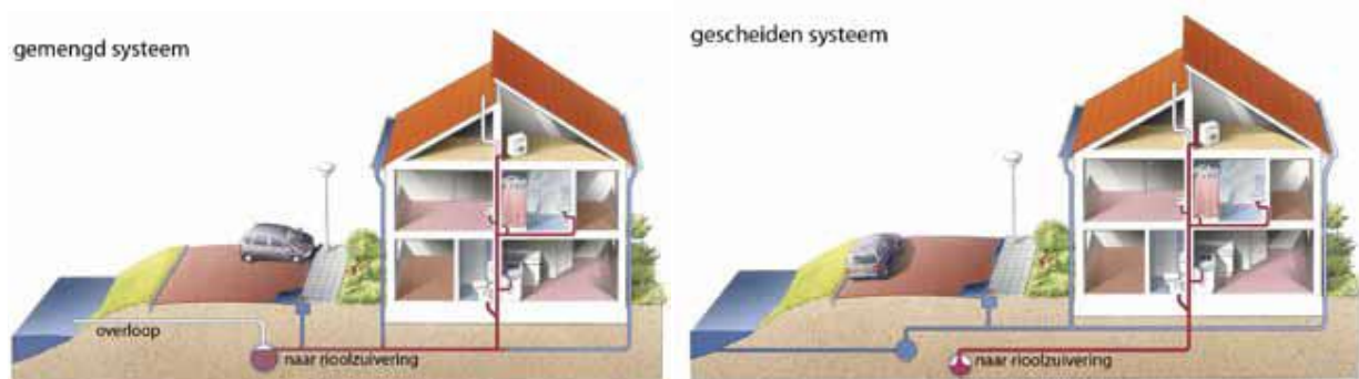
Figuur 4 - Verskil gemengd en gescheiden rioolstelsel (Gemeente Enschede, 2012a)
