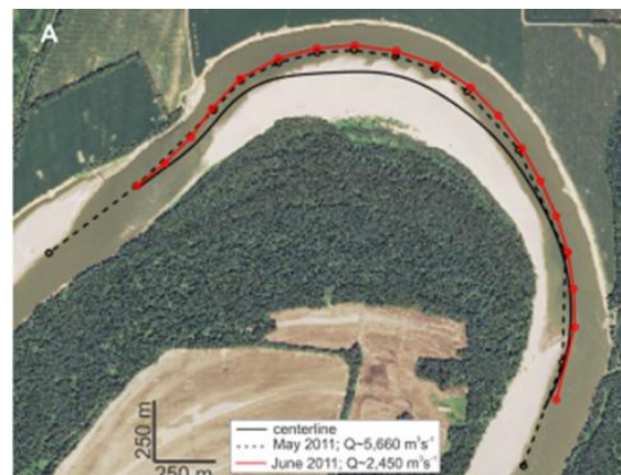
Figuur 13 As van rivier (centerline) en as van maximale snelheidsprofielen in een meander in de Wabash River (Konsoer & et.al., 2016)
