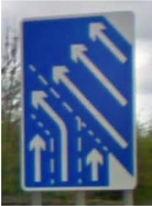
Figuur 15-36 Voorbeeld Engels verkeersbord van een ingeklemde invoeging met rechter afstreping bij een samenvoeging 3+3 -> 4 bij het knooppunt A1(M)/M1
