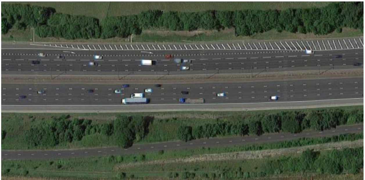
Figuur 15-37 Rechter afstreping in Engeland met verdrijfvlak, pijlen en blokmarkering (bij knooppunt A1(M)/M1)
