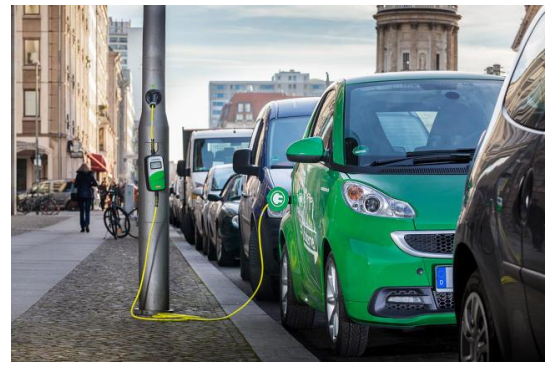
Figuur B8 (In Berlijn leveren lantaarnpalen stroom voor elektrische auto's, 2015)
