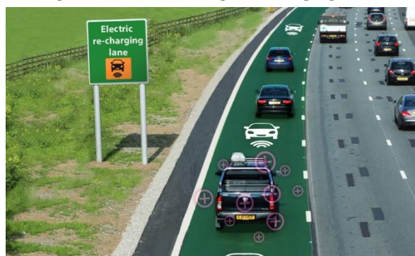
Figuur B11 Een mogelijk toekomstig uitwerking van dynamisch laden (New wireless charging tech will juice up your electric car as you drive it, 2015)
