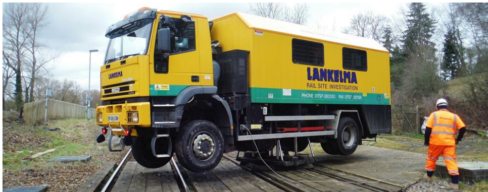
Figuur 21: Sondeer vrachtauto Lankelma (Ingenieursbureau Lankelma, 2018)
