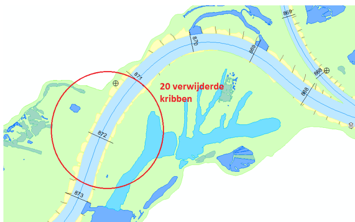
Figuur 3.4 Met behulp van ArcGIS Baseline zijn 20 kribben verwijderd. Kribben zijn geschematiseerd als dunne zwarte lijntjes zoals te zien is. De dikkere zwarte lijnen met getallen ernaast geven rivierkilometers weer.
