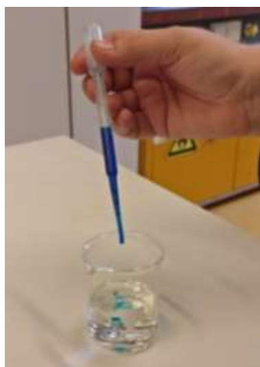
FIGUUR 11 DE OPSTELLING GEBRUIKT VOOR HET PRACTICUM DRUPPELS. HIERBIJ IS GEBRUIK GEMAAKT VAN EEN KUNSTSTOF PASTEUR PIPET, EEN BEKERGLAS VAN 100 ML
