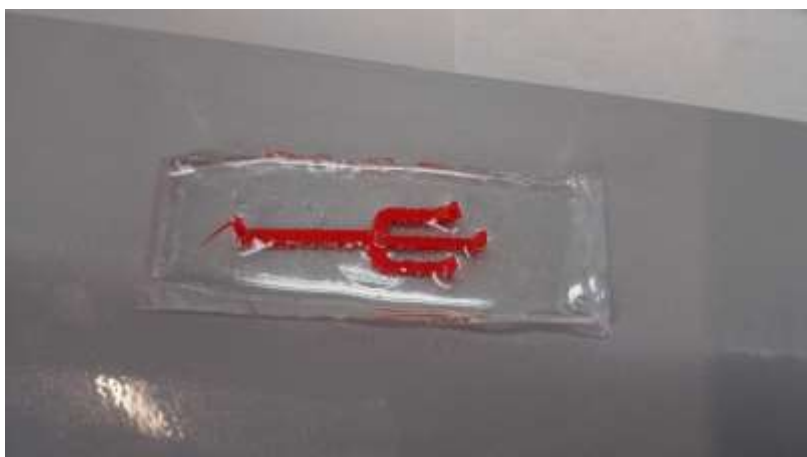
FIGUUR 6 EEN PROEF MODEL VAN EEN POLYMELKZUUR (PLA) KANAAL OVERGOTEN MET POLYDIMETHYLSILOXAAN (PDMS). GETRACHT IS DE PLA OP TE LOSSEN MET NATRONLOOG.
