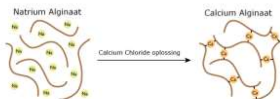
figuur 1: Omzetting van algiinaat oplossing naar algiinaat gel. [3]
