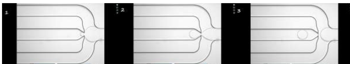
FIGUUR 13 SCREENSHOTS VERKREGEN UIT EEN VIDEO VAN MICRONIT MICROFLUIDICS (2014). IN BEELD HET MAKEN VAN OLIE IN WATER DRUPPELS IN CHRONOLOGISCHE VOLGORDE VAN 1 T/M 3. STROOMRICHTING IN HET MIDDEN VAN RECHTS NAAR LINKS, BOVEN EN ONDER VAN LINKS NAAR RECHTS.
