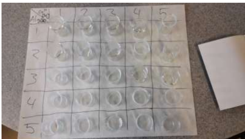
FIGUUR 7 TESTSCHEMA MET VERTICAAL DE ALGINAAT CONCENTRATIES, VAN 1 TOT EN MET 5 MM, HORIZONTAAL DE CALCIUMCHLORIDE OPLOSSINGEN, VAN 1 TOT EN MET 5 MM.
