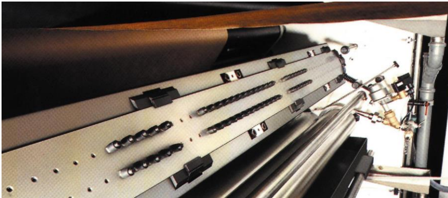
Figuur 7: Een foto van de lijmkop die lijmdots aanbrengt
