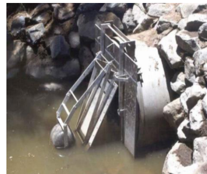
Figuur 26 Klepontwerp I: toevoeging drijver
