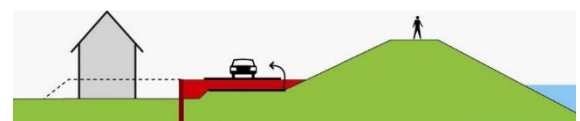
Figuur 31 Steunberm met een damwand Bron: (Royal HaskoningDHV, Verzwaring of aanleg van een binnenberm)
