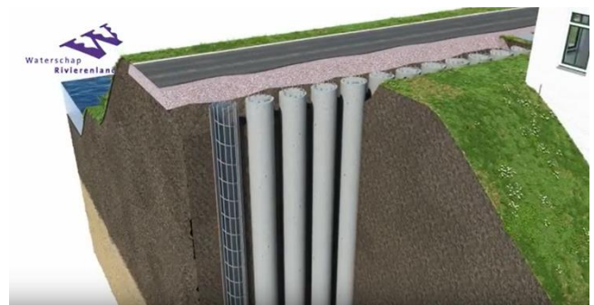
Figuur 33 Palenwand/Palenrij in de dijk kruin
