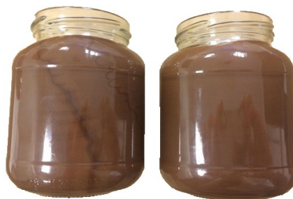
FIGUUR 2: LINKS: ZONDER STATISCHE MENER, RECHTS: MET MENER
