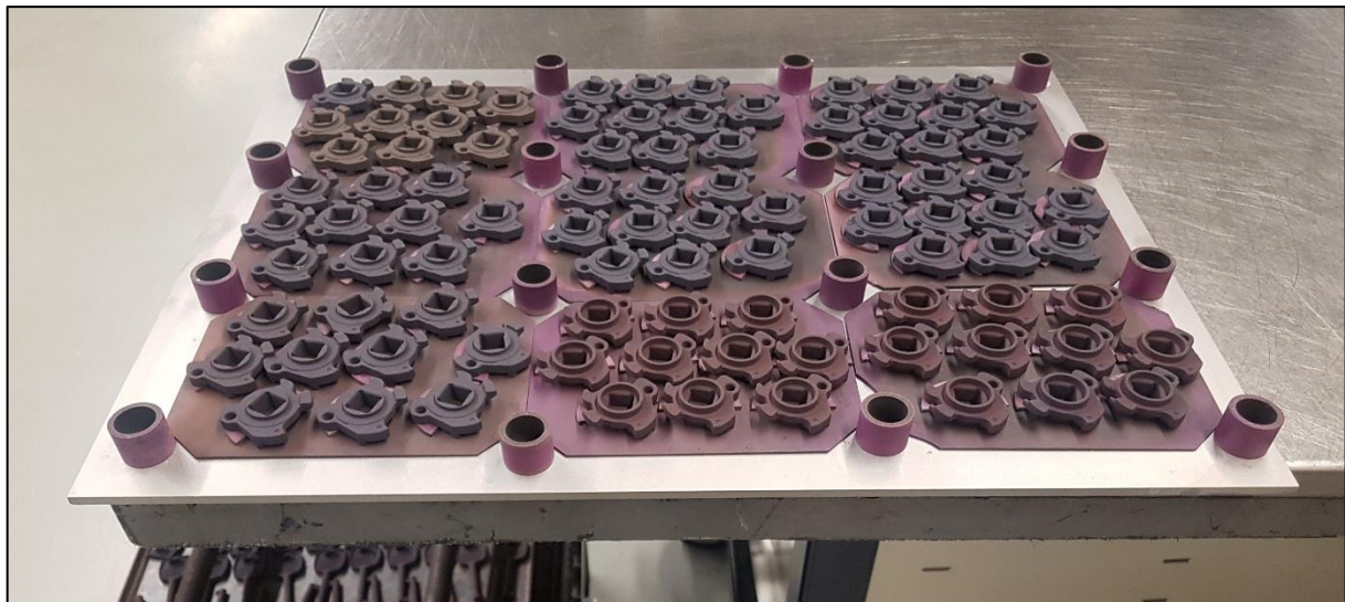
Afbeelding 3 - Debindplaat na het thermisch debinden en na het overstapelen.
