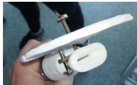
(b) Handschroefclip met ingeklemde buis.
