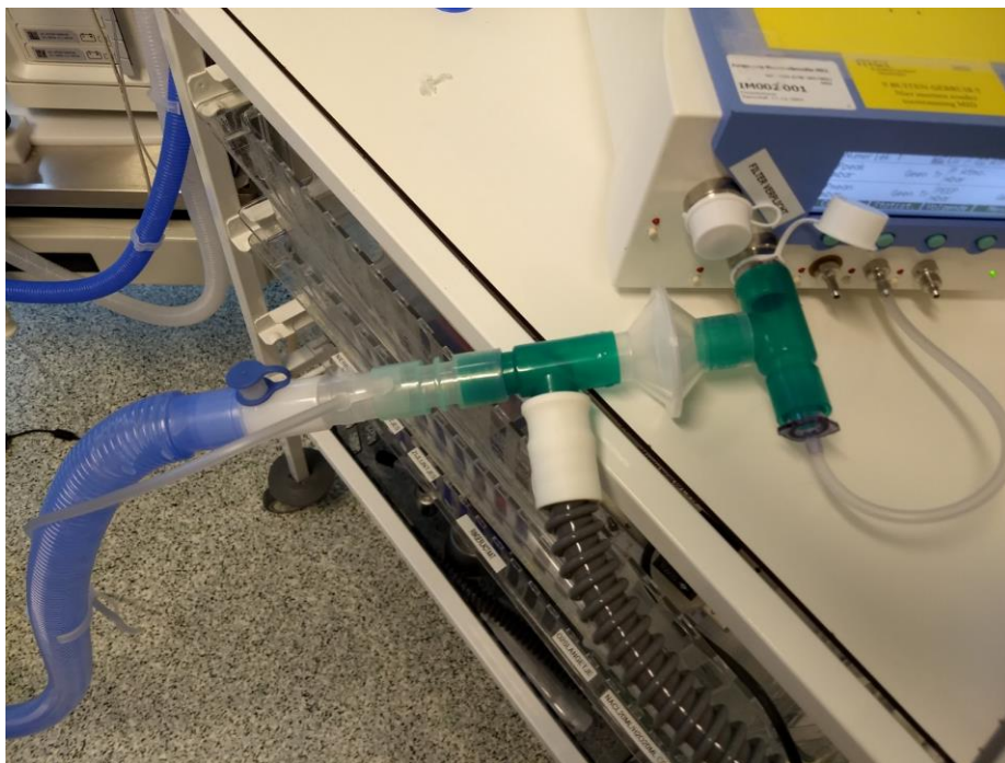
Figure 6: Koppeling beademingsmachine aan FlowAnalyser.
