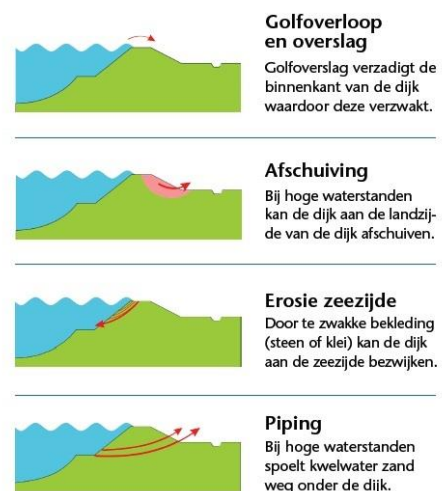
Figuur 1 - Hoofd-faalmechanismen. (Wetterskip Fryslân, z.d.-a)
