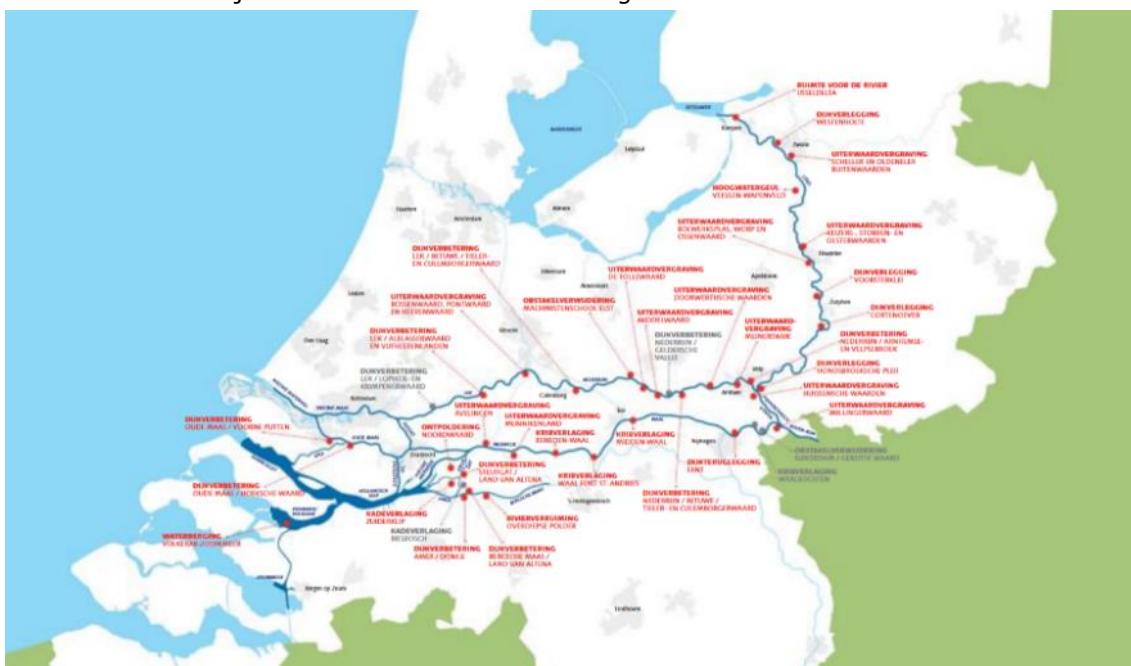
Figuur 2. Een overzicht van de uitgevoerde projecten in het kader van het Ruimte voor de Rivier programma. (Ruimte voor de Rivier, 2014)
