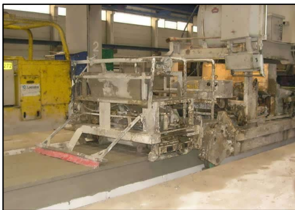
Figuur 14: Machine stort en vormt de vloeren op de baan [fabriek VBI te Huissen].
