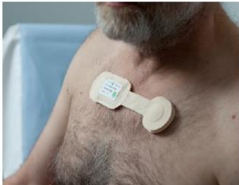
Figuur 1: Isansys LifeTouch sensor voor metingen van de hartslag, ademhaling en beweging
