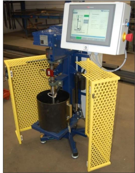
Figuur 1: Verwerkbaarheidsproef ontwikkeld door Boskalis (Poeran, Sluer, & Andeweg, 2014).
