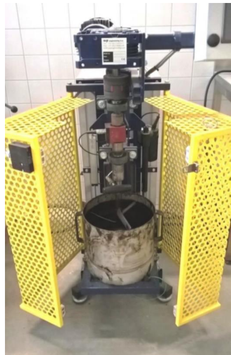
Figuur 11: Meetopstelling verwerkbaarheidsproef (Poeran & Sluer, 2016).
