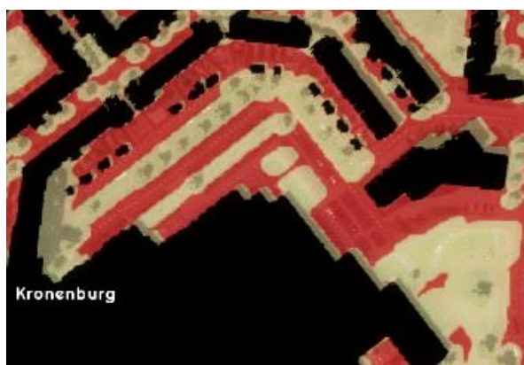
Figuur 16: Hittestress om 15u in ontwerpgebied na plaatsen van gras, heggen, bomen, groene gevels en daken
