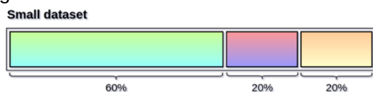
Figuur 12: Aanbevolen verdeling van een dataset bij het trainen van een Neural Network in het geval van een kleine dataset.[74]
