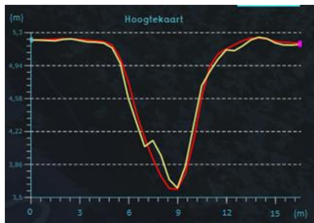
Figuur 4: Uitsnede digitaal hoogtemodel (AHN) (gele lijn) en het hoogtemodel waarmee Tygron rekent (rode lijn)
