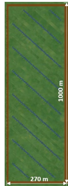
Figuur 19: Situatie gebruikt voor testen invloed angle of repose op het verschil in berging volume.
