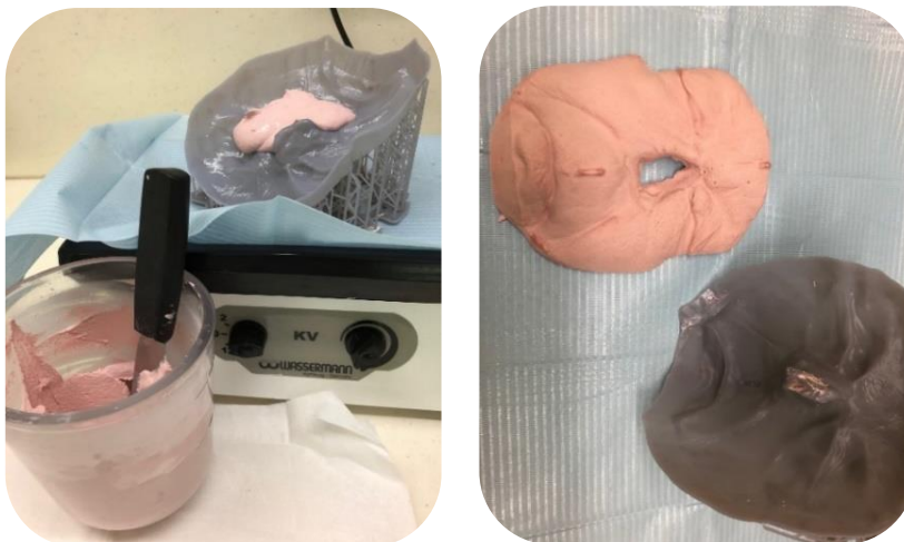
Figuur 12 Weergave van de 3D geprinte mal van fantoom 3 van Though 1500 Resin van Formlabs die wordt ingegoten met gips, waardoor een gipsfantoom gevormd wordt.
