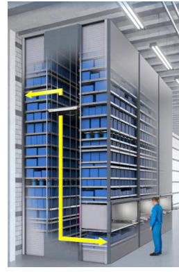
(b) Vertical lift module (Hänel, 2022a)
