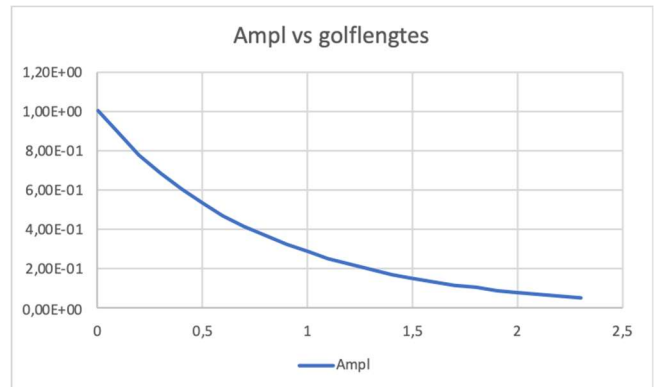
Figuur 22 Amplitude van de evanescente golf als functie van de barrierebreedte (in golflengtes). Zichtbaar is een exponentiele afname met de barrierebreedte.
