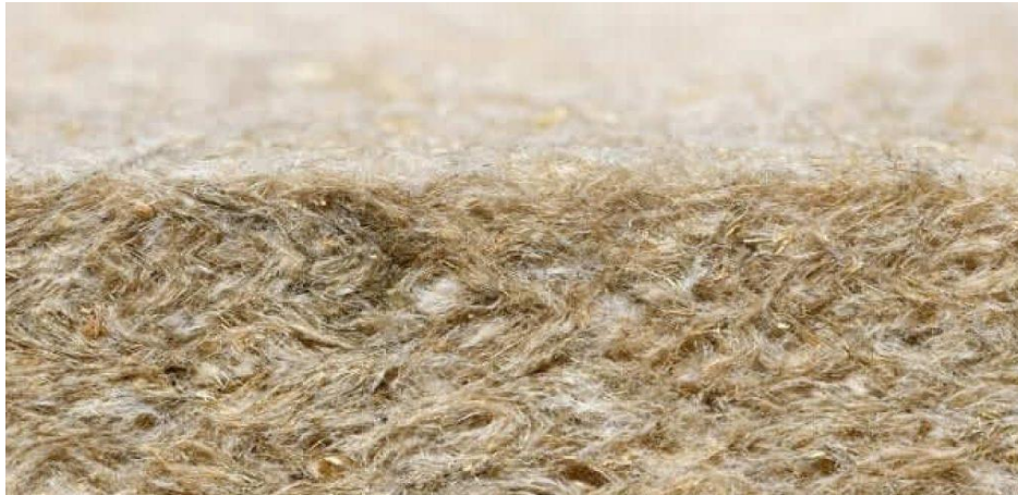
Figure 17: Flax insulation (Van het Westeinde, 2021)
