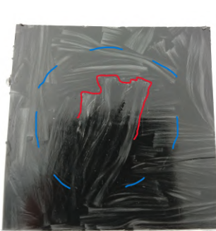
(d) Specimen G/PP-2 fracture on bottom
