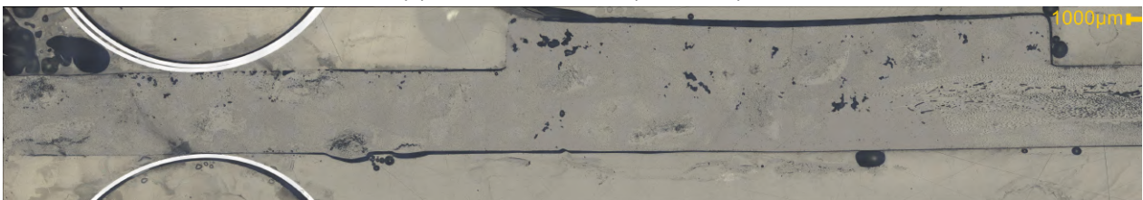
(d) Local round reinforcement 16x1.5 mm
