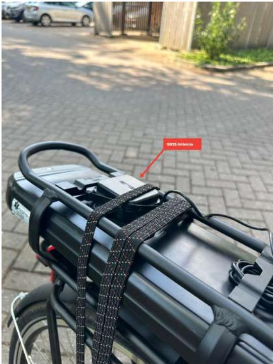
Fig. 7. GNSS antenna setup
