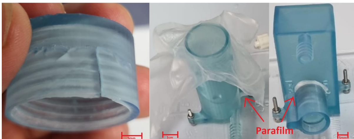
Figuur 16: Links is een kapotte dop te zien van het dopsysteem reservoir bij veelvoudig gebruik. Rechts laat het parafilm zien die is aangebracht op de reservoirs.
