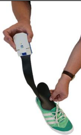
Figuur 2: De drukzool die in de ForceShoes gelegd zal worden. Het kastje is verbonden aan de zool, hiermee wordt de data opgeslagen.
