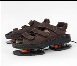
Figuur 3: De ForceShoes die worden gebruikt om de krachten onder de voeten te meten. Deze worden gedragen tijdens de meting.
