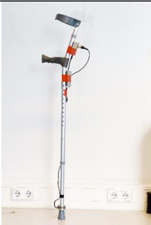
Figuur 1: Voorbeeld van een geïnstrumenteerde kruk. Het systeem gebruikt 2 van deze krukken.
