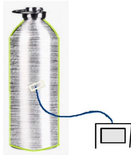
(b) Conductiemetingen: dikte en materiaal hoes variabel
